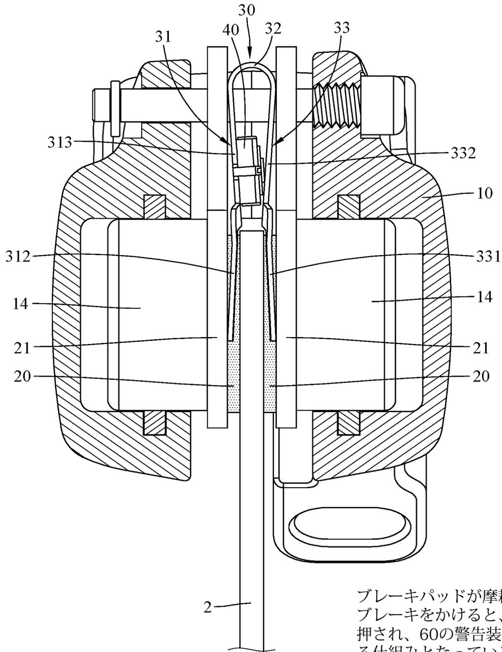
ブレーキパッドが摩耗している状態でブレーキをかけると、40のスイッチが押され、60の警告装置に信号が送られる仕組みとなっている。
